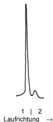
Abbildung 5-2: Elutionsdiagramm der Gelfiltration zur Überprüfung der vollständigen Abtrennung nicht umgesetzten 2-Iminothiolans von modifizierter POD. Eluiert wurde mit 5 mM EDTA-Phosphatpuffer.
