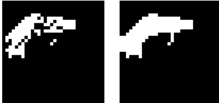
Abbildung 4: Silhouettenbild des Roboters vor und nach der Nachbearbeitung
