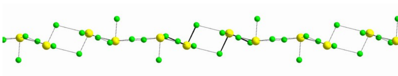
Abb. 61: (\text{SbCl}_3)_\infty -Ebene in [(1,3,5\text{-Me}_3\text{C}_6\text{H}_3)\text{SbCl}_3] , Seitenansicht
