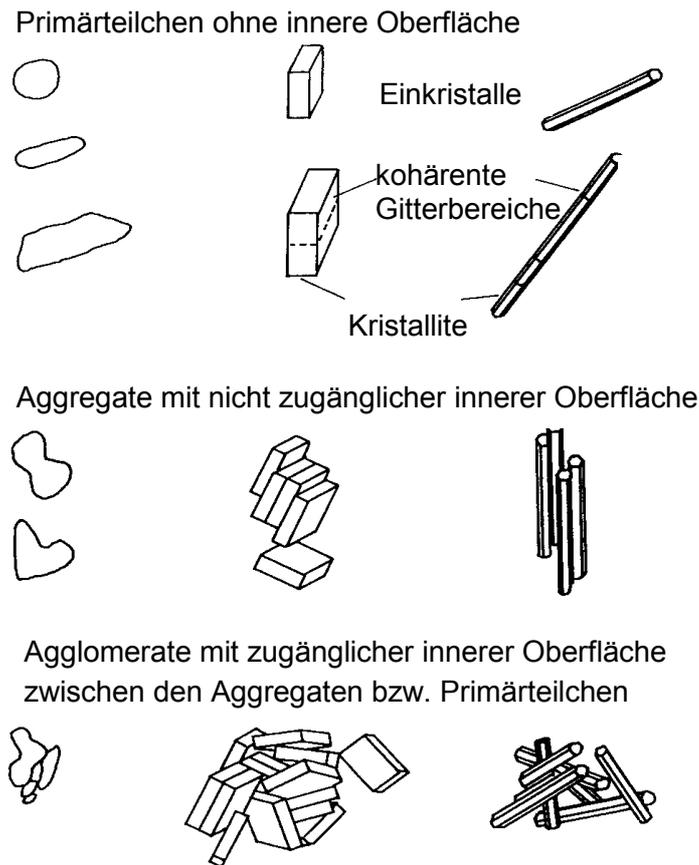
Bild 25: Prinzipdarstellung der Primärteilchen, Aggregate und Agglomerate (nach DIN 53206)
