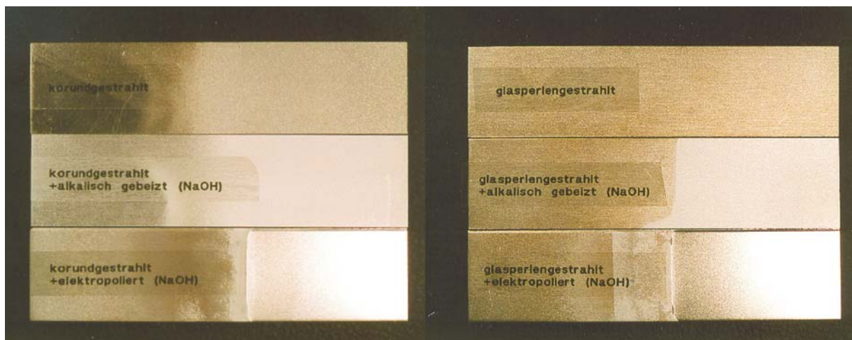
Bild 2: Optisches Aussehen der Fügeiteiloberflächen nach verschiedenen Vorbehandlungsschritten
