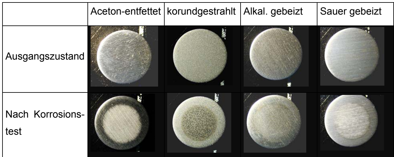
Bild 7: Korrosionsbilder nach Stromdichte-Potentialmessungen
