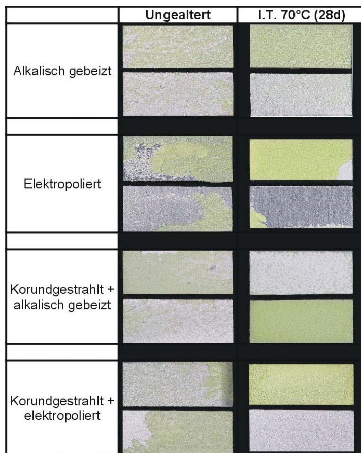
Abbildung 27: Bruchflächen der unterschiedlich vorbehandelten \tau - \gamma -Proben
