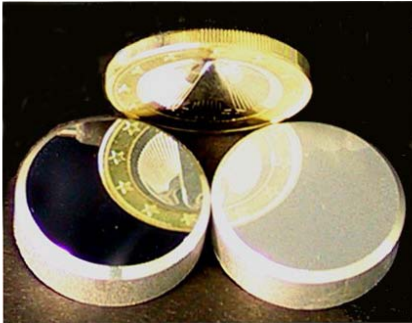
Bild 8: UP-gedrehte Aluminiumoberflächen vor und nach Beizen in konz. Salpetersäure
