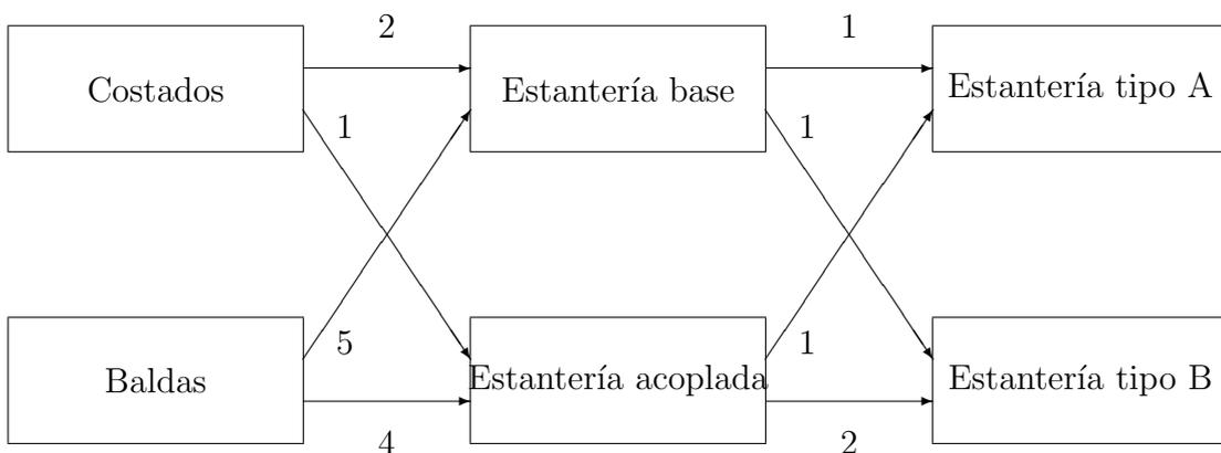
Figura 2.3: Flujo del material modificado de la empresa de muebles
