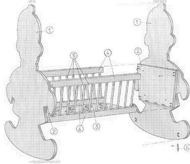
Figura 2.4: cuna-Baby "Sofia" (1 =Respaldos, 2 =Placas frontales, 3 =Placa base, 4 =Barandillas, 5 =Barrotes, 6 =Frenos)
