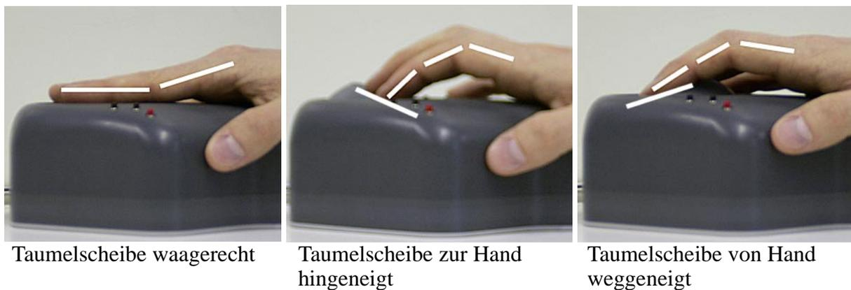
Abb. 8.3: Gelenkstellungen bei verschiedenen Neigungen der Taumelscheibe
