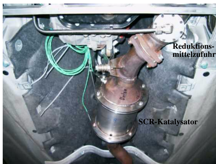
Abbildung 11.1 Abgasanlage mit Reduktionsmitteleindüsung und SCR-Katalysator
