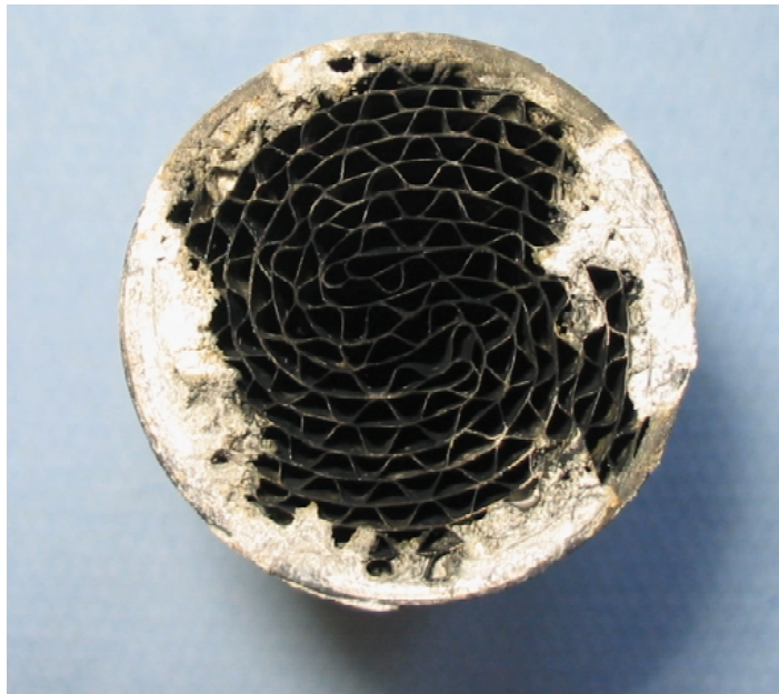
Abbildung 10.30 Ablagerungen bei inhomogener Heizflächentemperatur, d.h lokal zu niedriger Heizflächentemperatur
