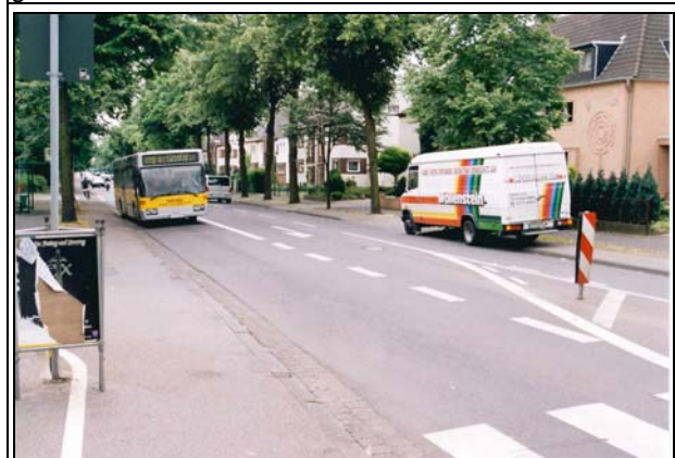
Bild – A 16: "Leverkuser Lösung", IV-Spur als Fahrstreifenreduzierung
