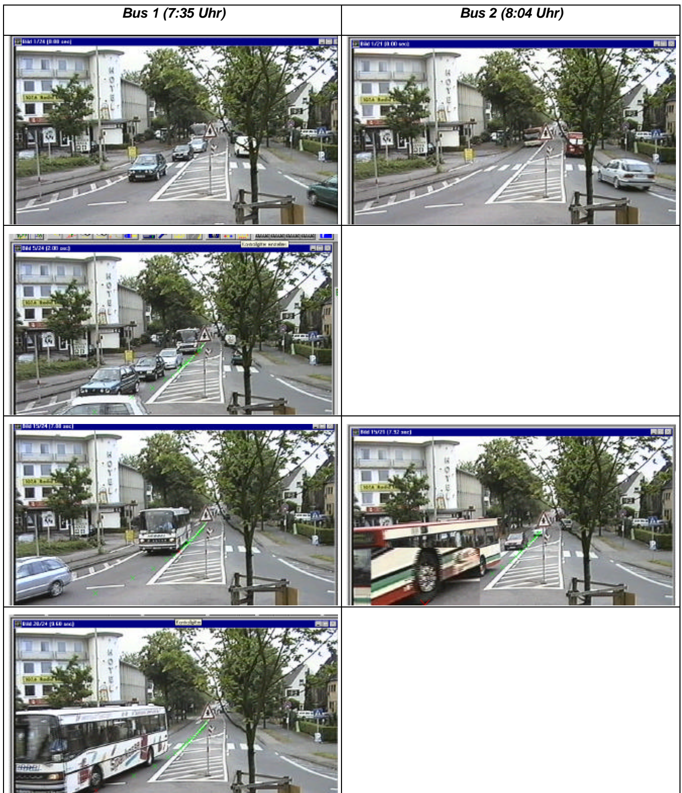
Abbildung 87: Vergleich zweier einfahrender Busse (links: Während des Haltestellenaufenthalts von Fahrzeugen überholter Bus muß an der Einfahrt auf die Kreisfahrbahn warten; rechts: Bus kann unbehindert von anderen Fahrzeugen bis zur Kreisfahrbahn durchfahren)
