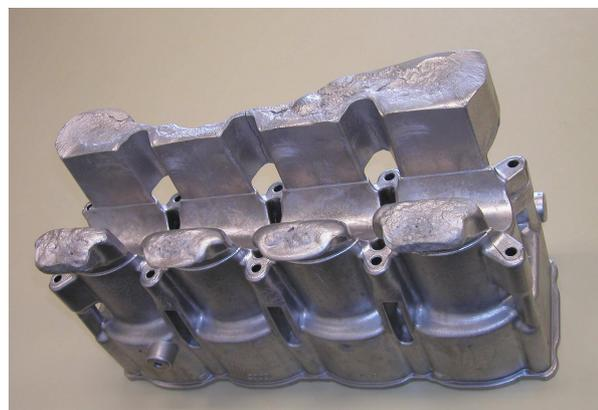
Bild 8.2: Zylindereinsatz-Rohteil
