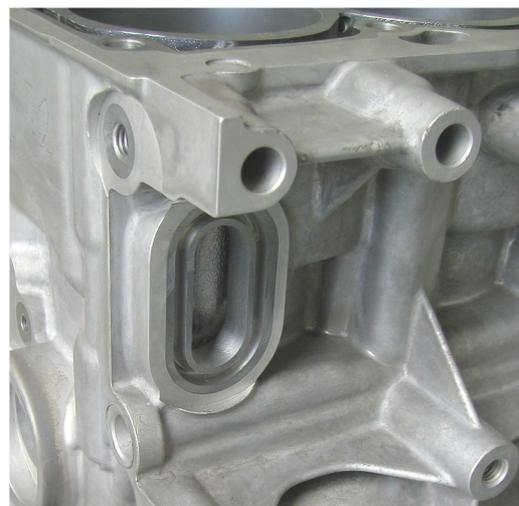
Bild 8.26: Detailansicht Kühlwasserzulauf
