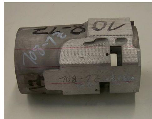
Bild 6.20: Herstellung der Schliffproben durch Drahterodieren /87/
