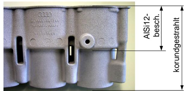
Bild 8.7: Vorbereitung des Zylindereinsatzes vor dem Eingießen
