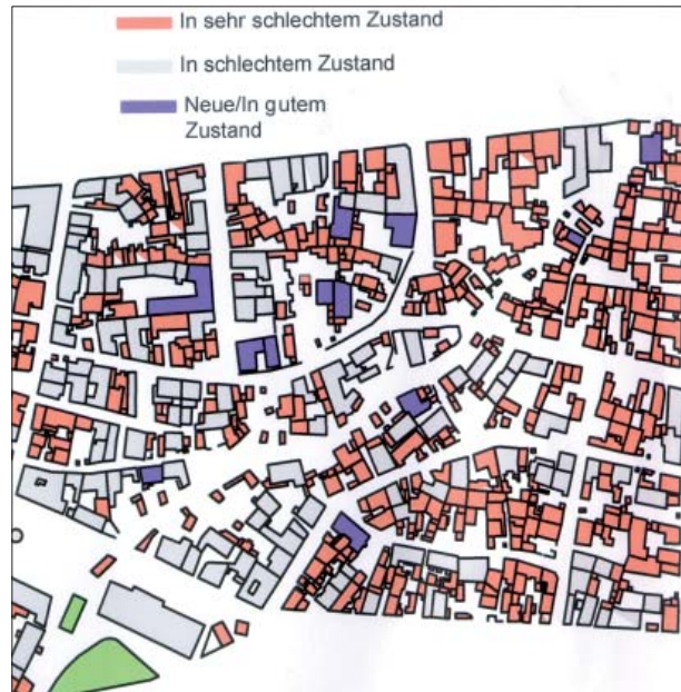
Karte 24: Erhebung des Bauzustandes im Stadtteil Avlabari - Tbilisi durch Studierende der TU Tbilisi, 2004
