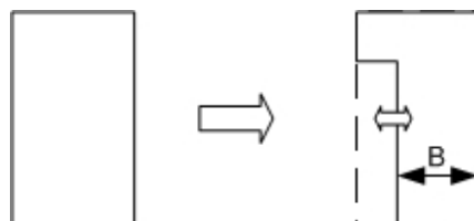
Abb. 5.5.8 KWA-Endstück mit Rechteck-Kontur (Variante 2, B_{\max}=\tau_p )
