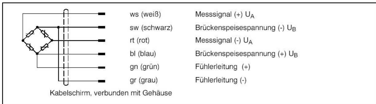
Abb. 3.2.2 Belegung der Kabeladern (Sechsheiterschaltung)
