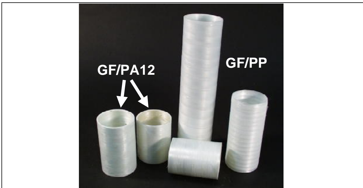
Bild 4.43 Mit der Prozesskombination hergestellte Rohre
