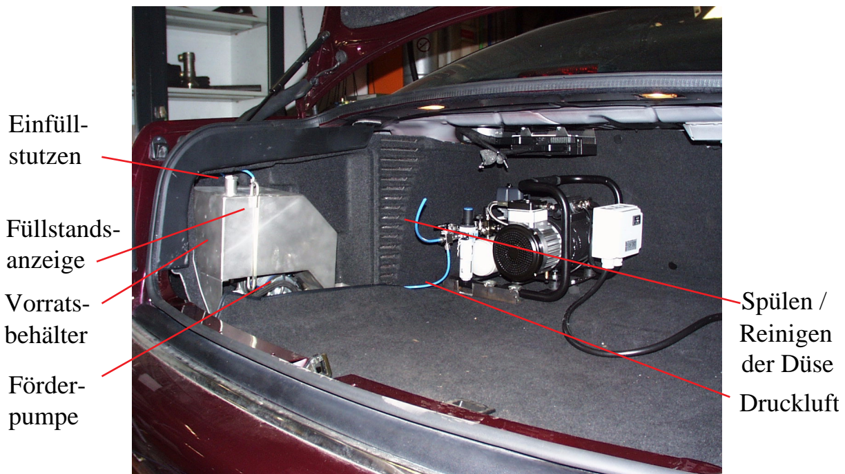
Abbildung 5.6: Harnstoffvorratsbehälter und Kompressor im Kofferraum
