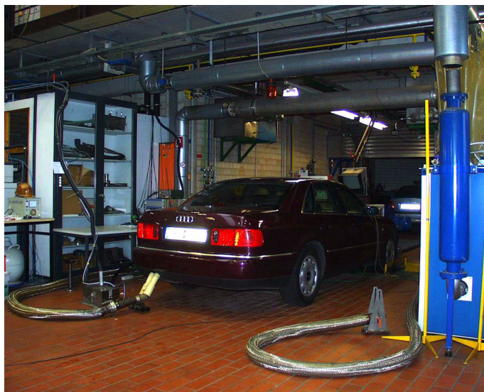
Abbildung 5.4: Versuchsfahrzeug Audi A8 2,5 TDI mit Harnstoff-SCR-Anlage
