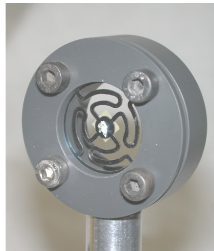
Abbildung 3.10: Schwingplatte (a) schematisch und (b) mit einem Gehörknöchelchen (Amboss) in der Halterung montiert.
