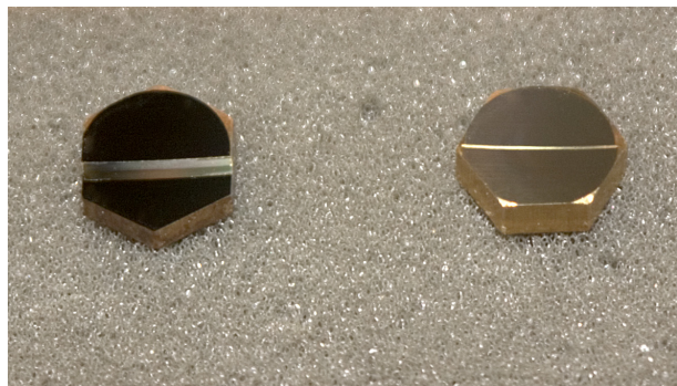
Abbildung 4: Planflächen mit definierten Stufen
