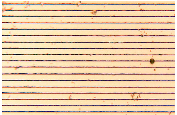
Abbildung 7: Gitterstruktur, Gitterkonstante 5 \mu\text{m}
