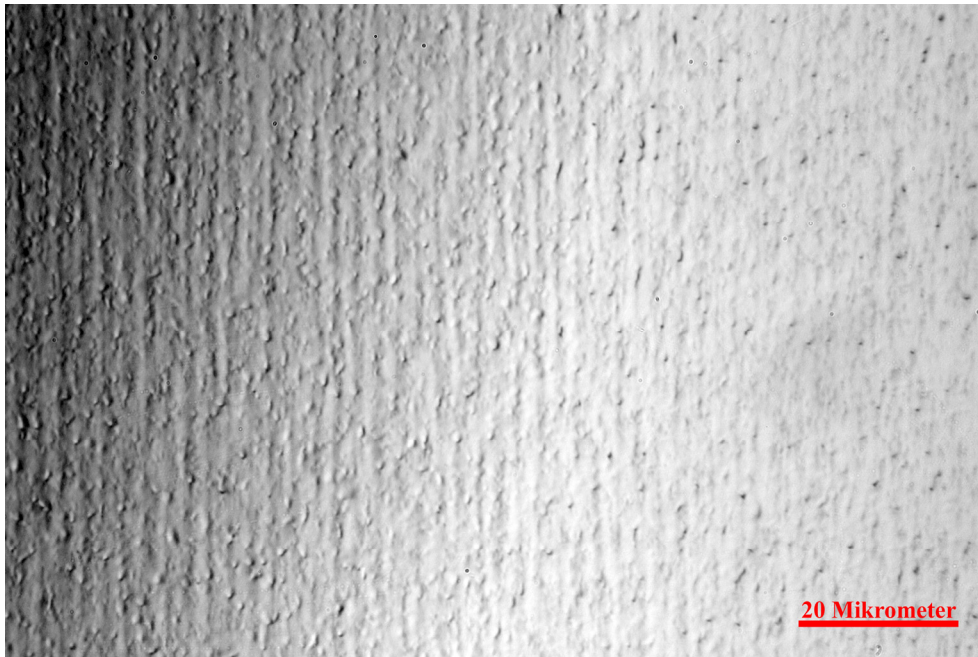
Abbildung 31: Planfläche CuSn8, Mikroskopaufnahme
