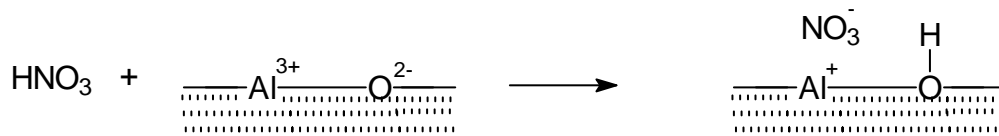
Abbildung 3.3-2: Adsorption von Salpetersäure
