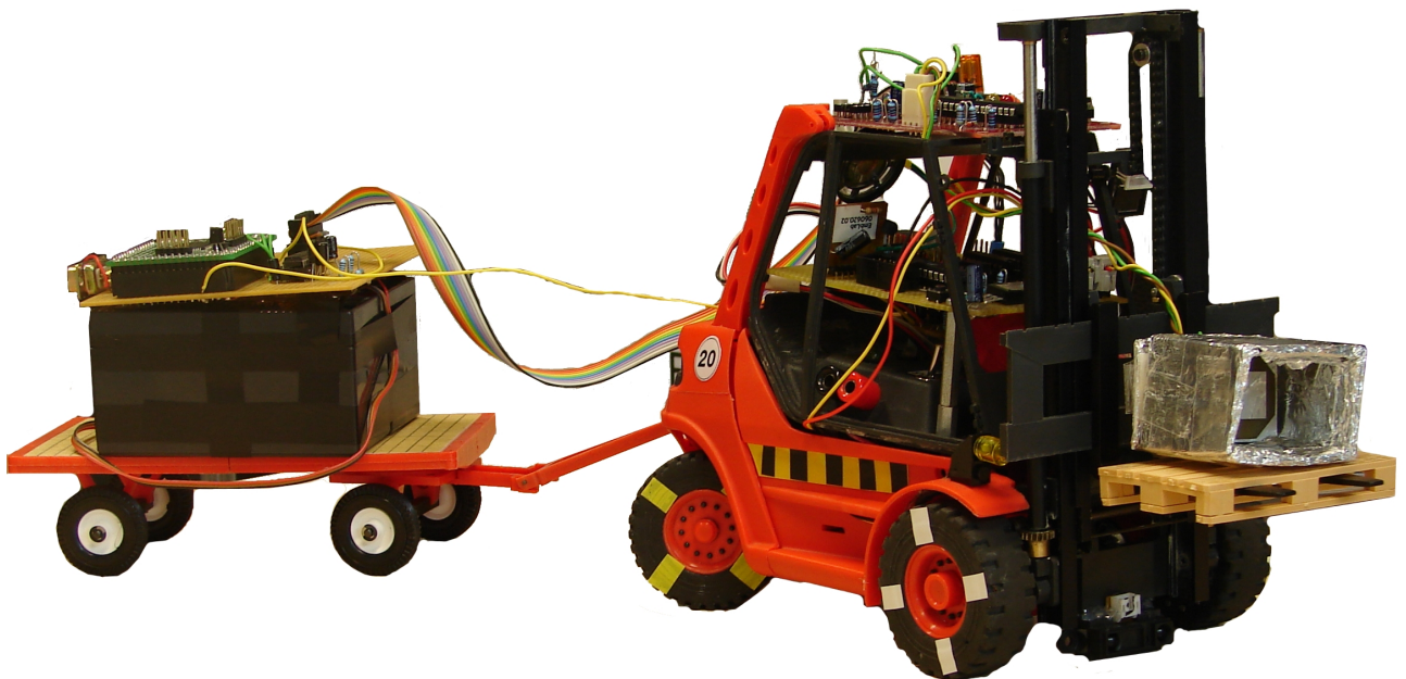
Abbildung 6.2: Gabelstapler mit Antikollisionssystem
