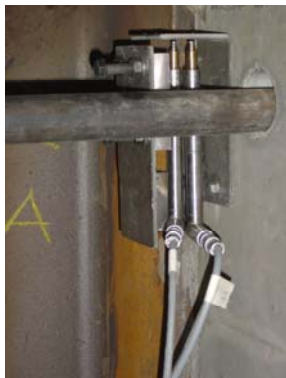
Bild 3.10 Detailansicht Steuerwegaufnehmer A4 (vorne) und Kontrollwegaufnehmer A4 (hinten) und Nomenklatur der Wegaufnehmerbezeichnung (Blick von vorne auf die Betonplatte)
