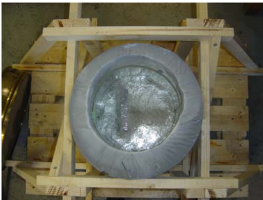
Bild 3.12 (a) Kopfbolzendübel im Stickstoffbad und (b) stickstoffgekühlte Probe nach Entfernen des Bolzens durch Sprödbrech
