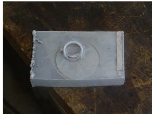
Bild 3.12 (a) Kopfbolzendübel im Stickstoffbad und (b) stickstoffgekühlte Probe nach Entfernen des Bolzens durch Sprödbrech
