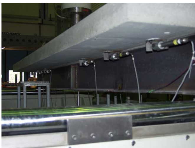
Bild 3.46 Untersicht des Versuchskörpers T8_1 mit Wegaufnehmern zur Schlupfaufzeichnung
