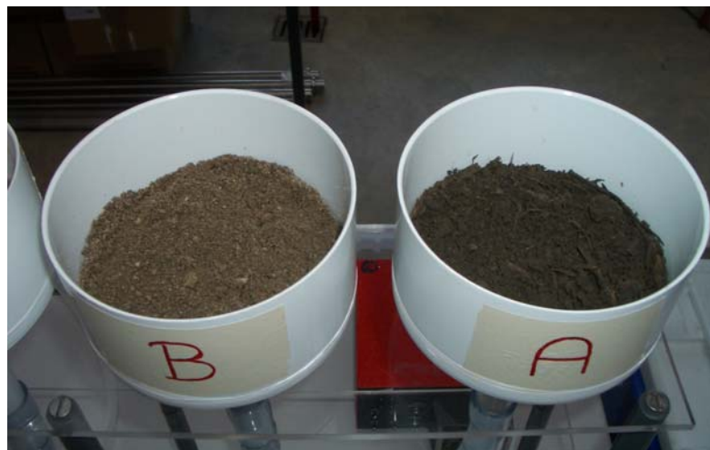
Bild H-2: Eingebaute Sand- (links) und Sedimentproben (rechts)
