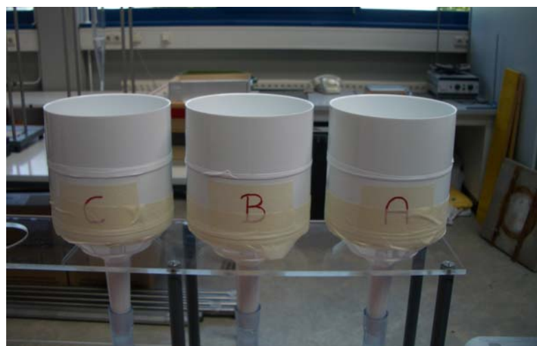
Bild H-3: Nutschen mit zweitem Deckelteil für den Überstau
