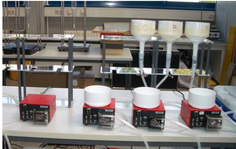
Bild H-1: Gesamtaufbau der Laborversuche zur \text{NH}_4 -Sorption
