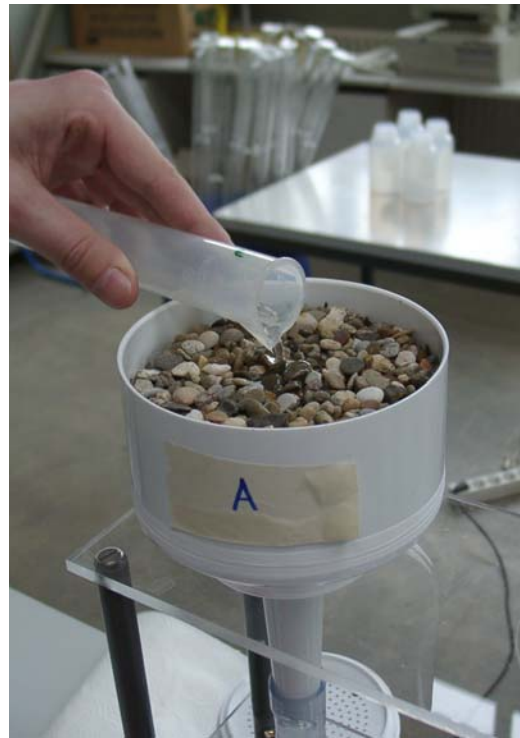
Bild I-2: Sättigung der eingebauten Probe
