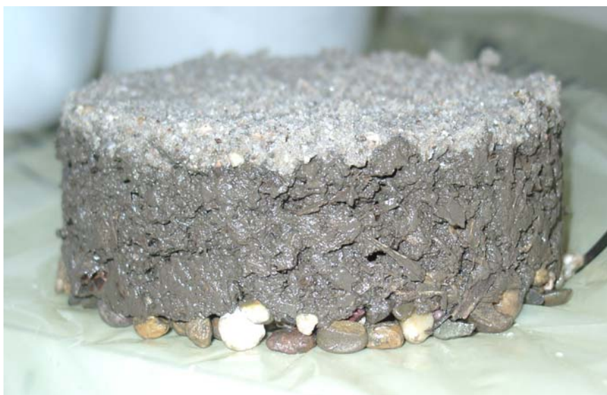
Bild I-3: Probenkörper nach Ausbau (gestürzt). Schichtung: Dränschicht (Sand), Sedimentprobe, Kies (Erosionsschutz)
