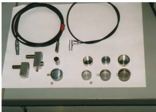
Bild 2.2: Kapazitiver Abstandssensor, konstruiert und gefertigt am Lehrstuhl für Feinwerktechnik
