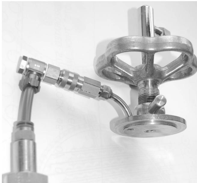
**Bild 4-3** Druckmessstutzen am Deckel des Laborfilters
