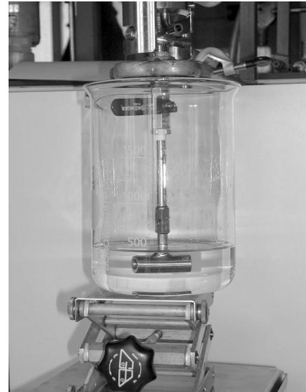
**Bild 4-10** Laborfilter 400 ml mit Standardablauf und Stopfen. Der Stopfen verhindert Ablauf von Filtrat vor Filtrationsbeginn.
