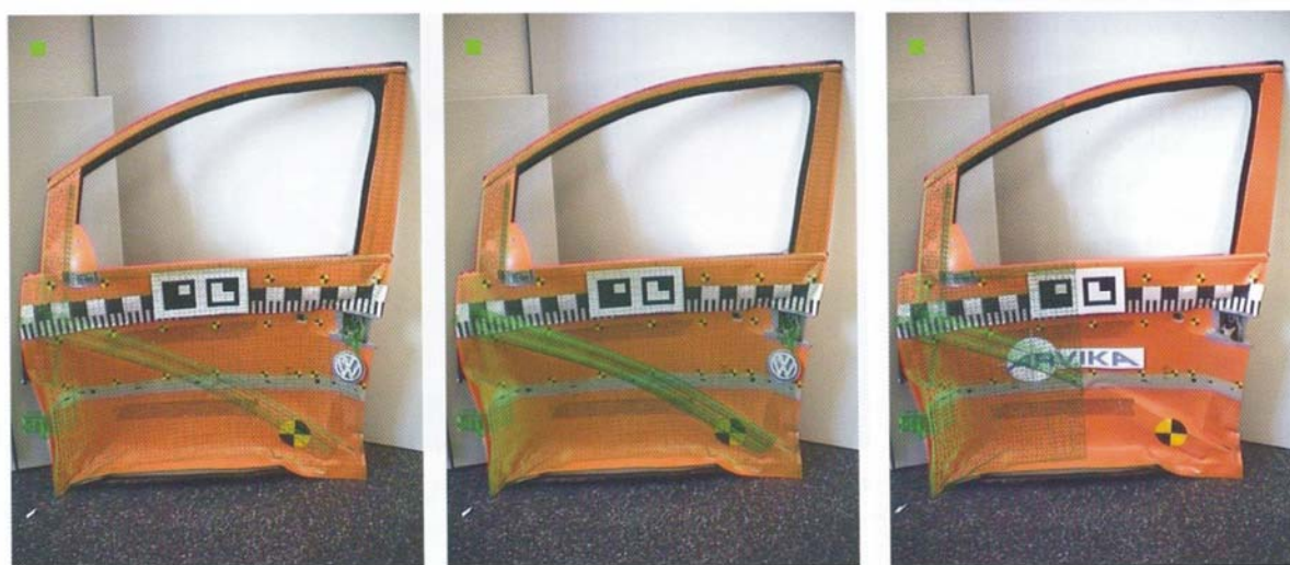
Abbildung 102: Überlagerung eines realen Crashtestergebnisses mit Ergebnissen einer virtuellen Crashtestsimulation [Friedrich (2004) S.105]
