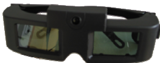
Abbildung 52: Aktives Bildtrennungsverfahren / Shutterbrille [Beck (2006)]
