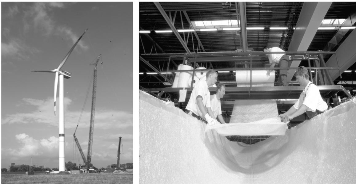
Bild 1.1: REPower 5M Windkraftanlage mit Rotorblättern von LM Glassfiber (Rotorblattlänge: 61,5 m; Rotorblattgewicht: ca. 18 t); Einbringen eine Glasfaserfließhilfe in eine Rotorblatthalbschalenform
