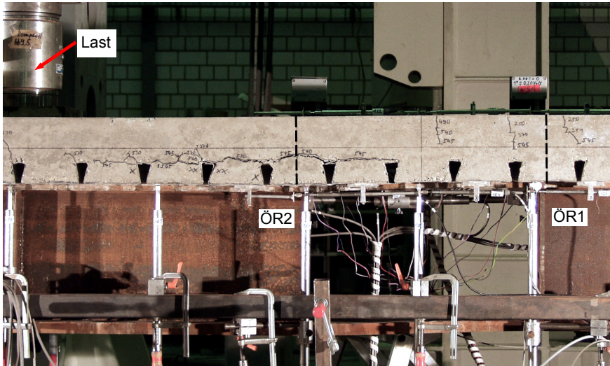
Abb. 5.37: Abtrennen der Betonrippen bei Versuch T3PPB
