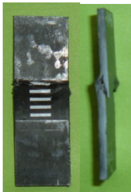
Abb. 6-48: Röntgenbild mit Bruchzone, lokale E-Moduli aus Druckversuch und Bruchbild, Druckschwellbelastung, (Gewebeverstärkter Thermoplast, Entnahmerichtung längs, Charge 1, 5 Hz, RT, Streifenabstand 3 mm, Probe ALT 20)
