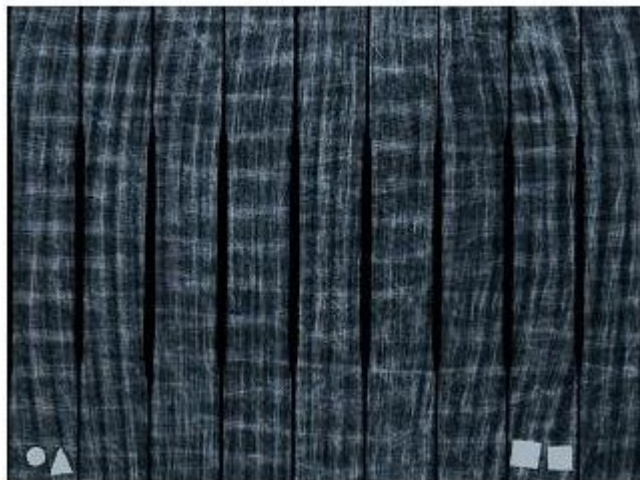
Abb. 3-9: Röntgenaufnahme der gepressten Platte und der daraus hergestellten Probekörper (Platte 300x300 mm, Gewebeverstärkter Thermoplast; Glasfasergehalt 40 Gew.-%, EP3a, 1. Charge)
