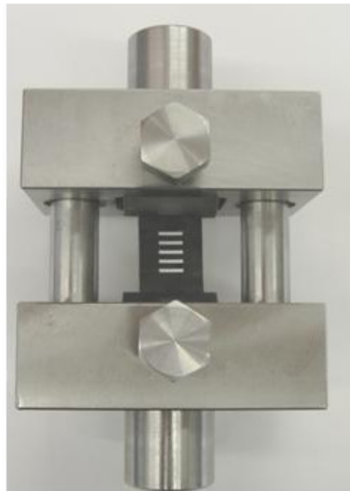
Abb. 4-1: Vorrichtung für statische und dynamische Druckversuche
