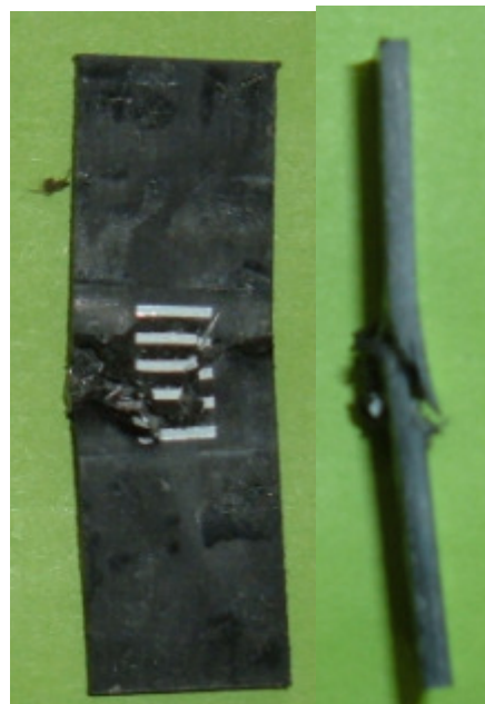
Abb. 6-50: Röntgenbild mit Bruchzone, lokale E-Moduli aus Druckversuch und Bruchbild, Druckschwellbelastung (Gewebeverstärkter Thermoplast, Entnahmerichtung quer, Charge 1, 5 Hz, RT, Streifenabstand 5 mm, Probe ALT 15)
