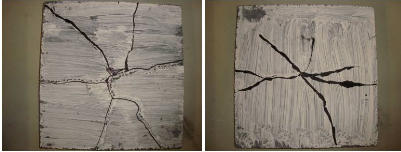
Abb. F.1: Biegeversagen nach dem Versuch mit den 160 mm und den 130 mm Ringauflagern
