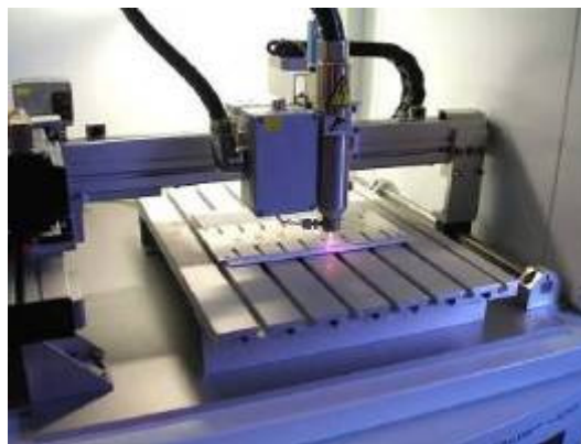
Abb. 4.8: Anlage zur Atmosphärendruckplasmabehandlung [96]
