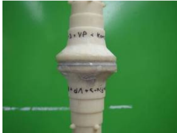
Abb. 4.9: Klebstelle zwischen zwei Ankerköpfen [96]
