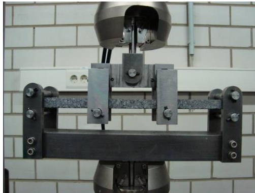
Abb. 3.9: Prüfung der Biegezugfestigkeit vom Referenzbeton 1
