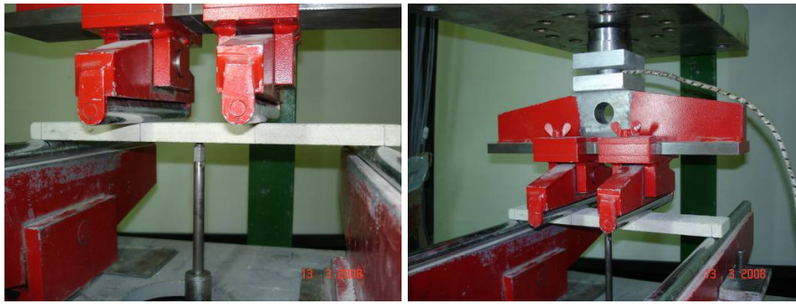
Abb. 5.15: Versuchsstand der Biegezugversuche nach EN 1170-5
