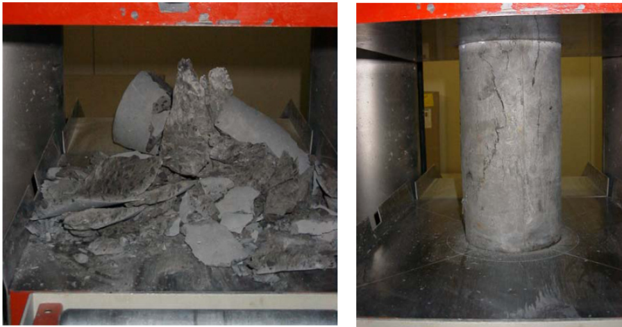
Abb. 2.4: Prüfzylinder ohne Stahlfasern und Prüfzylinder mit 2,5 Vol.-% Stahlfasern [83]
