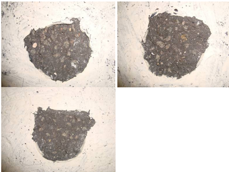
Abb. C.460: Versagen des Versuchs mit der 3 mm dicken Klebstoffschicht nach 3 Tagen und unter einer Belastung von 1,1 kN
