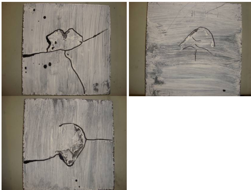
Abb. F.2: Durchstanzversagen nach dem Versuch mit dem 91 mm Ringauflager
