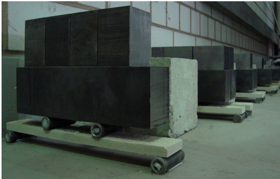
Abb. 5.25-2: Versuchsstand zur Untersuchung des Langzeitbiegeverhaltens von Glasfaserbeton
