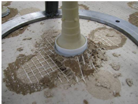
Abb. 4.16: Bruch des Betons während des Haftzugversuches [96]
