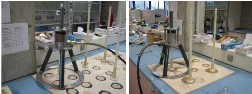
Abb. 4.15: Geklebte GfK-Anker auf Referenzbeton 2 [96]
