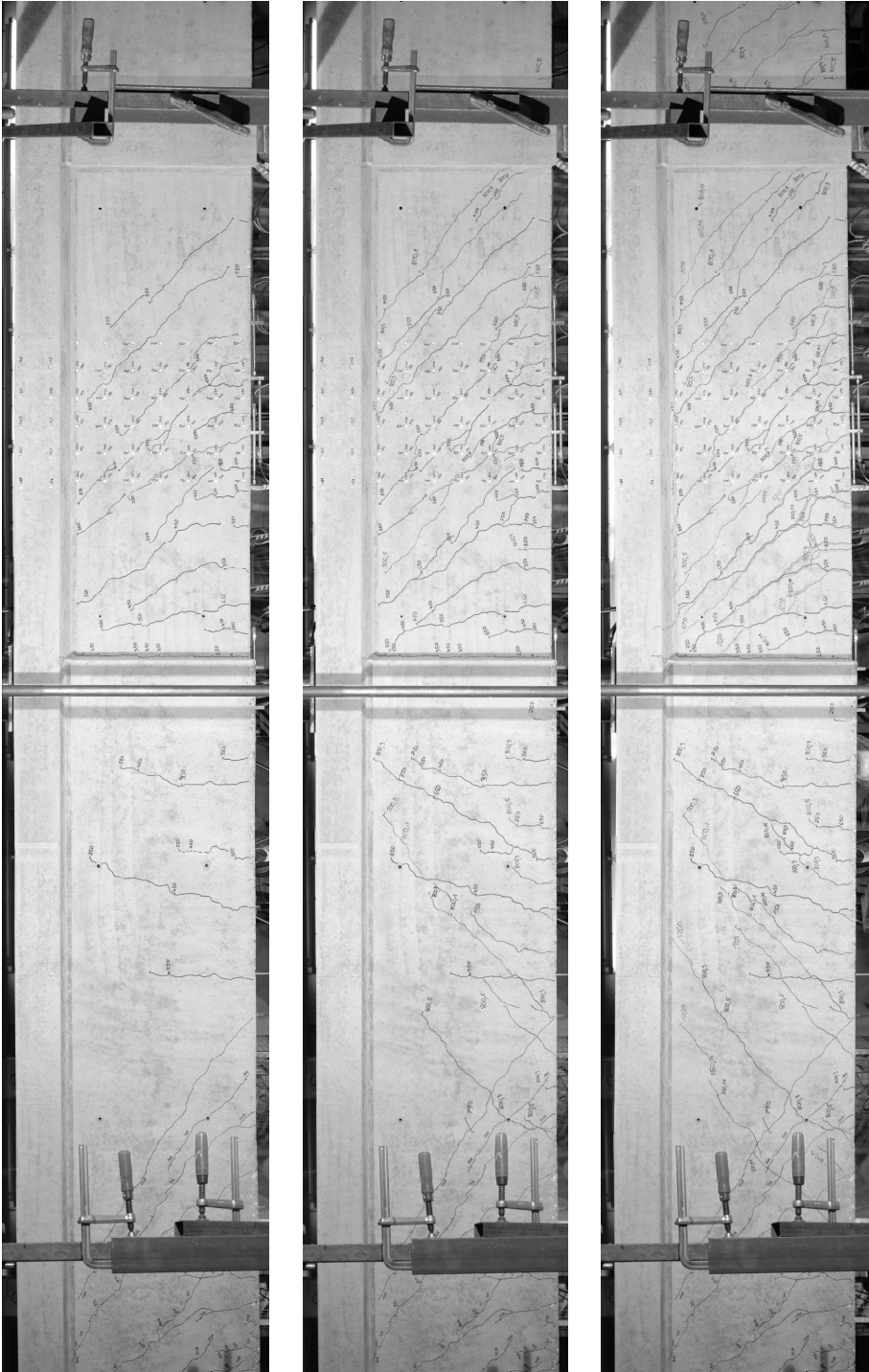
Abb. A-3.2: Versuch A-1: F_1 = 550 \text{ kN} , F_1 = 800 \text{ kN} + F_2 = 100 \text{ kN} , F_1 = 1200 \text{ kN} (von links).
