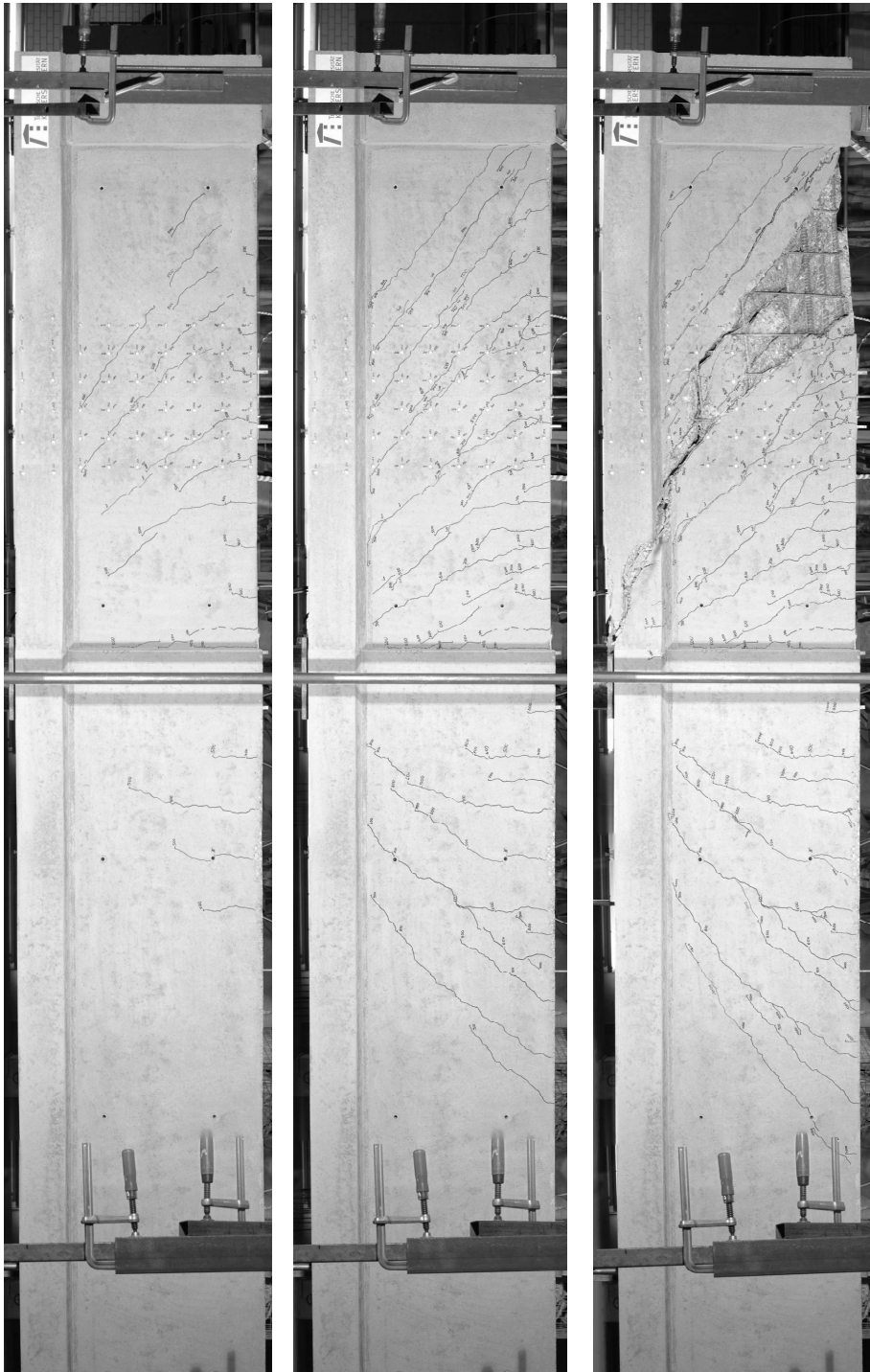
Abb. A-3.1: Versuch A-2: F_1 = 500 \text{ kN} , F_1 = 900 \text{ kN} und Bruchzustand (von links).
