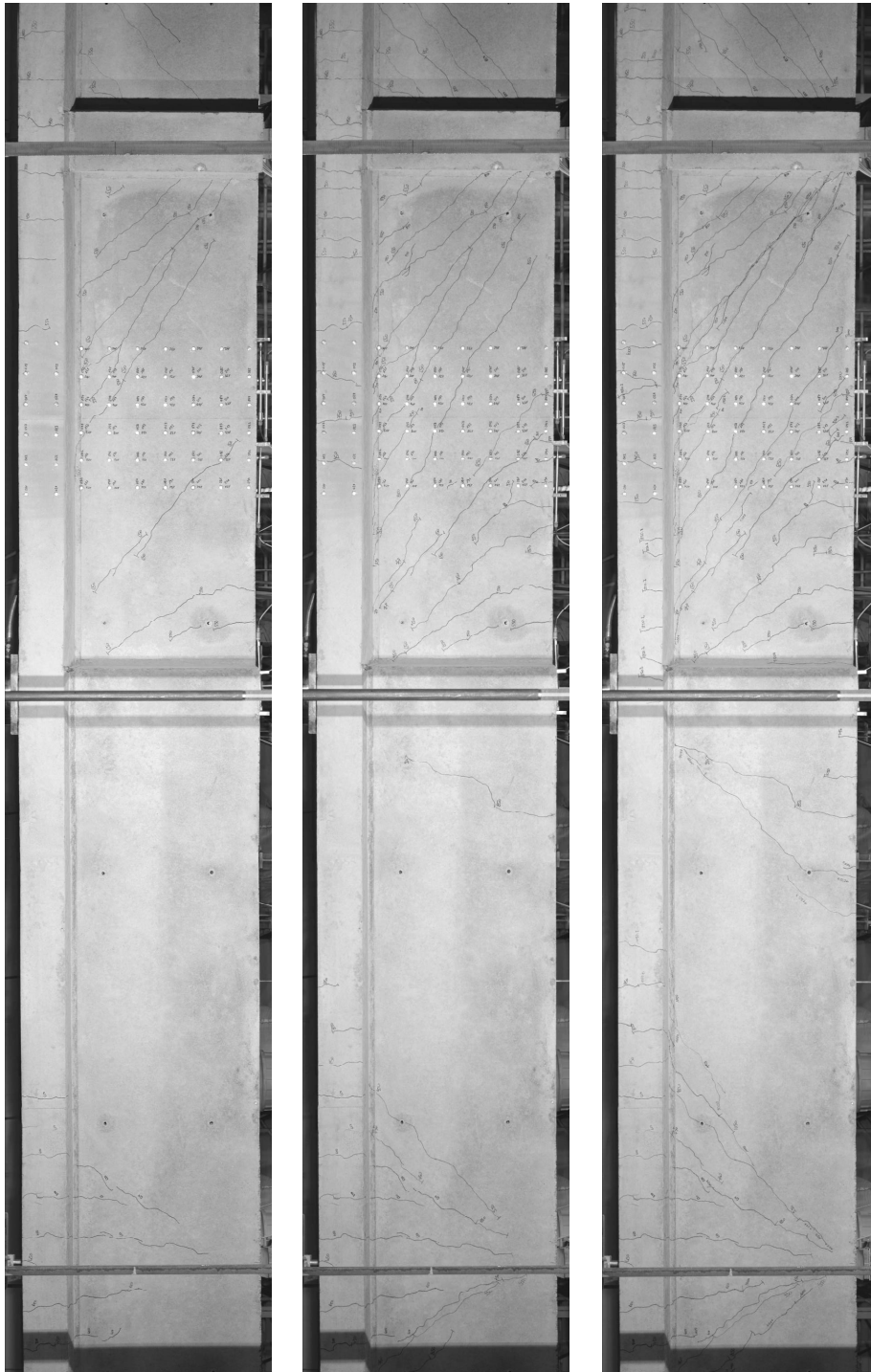
Abb. A-3.3: Versuch B-1: F_1 = 650 \text{ kN} , F_1 = 950 \text{ kN} , F_1 = 1150 \text{ kN} (von links).
