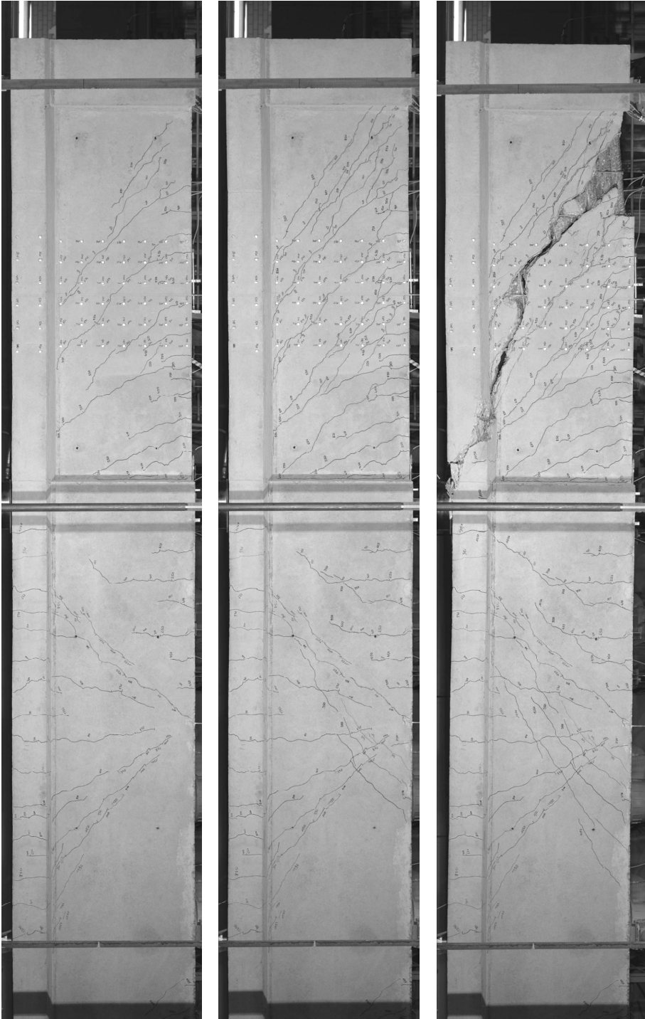
Abb. A-3.4: Versuch B-2: F_1 = 550 kN, F_1 = 950 kN, Bruchzustand (von links).
