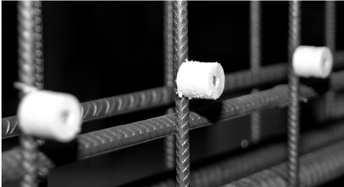
Abb. 5.17: Ausgeführte Ummantelung der Messbolzen mit Polystyrol.
