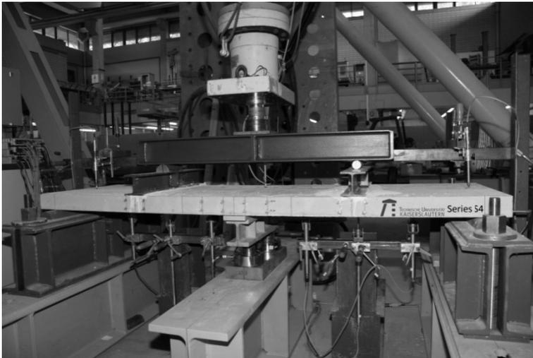
Abb. 4-13: Versuchsstand – Serie S4
