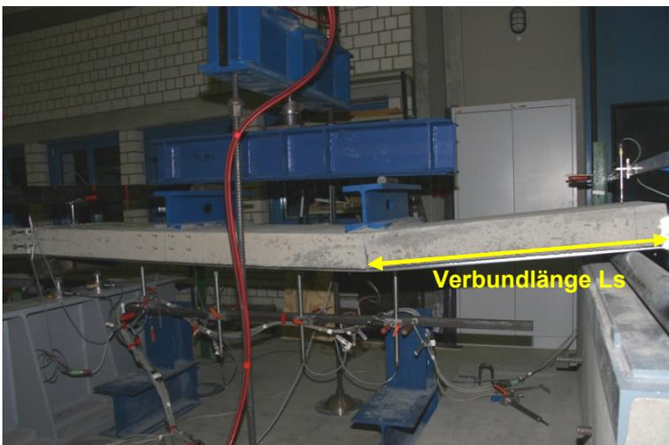
Abb. 4-38: Längsschubversagen eines Versuchskörpers aus Serie S2
