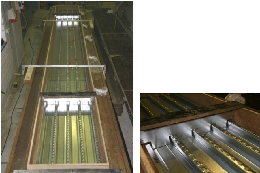
Abb. 4-16: Verbunddecke der Serie S2 mit applizierten DMS vor der Betonage,
