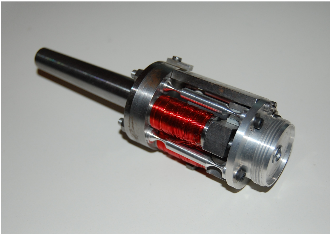
Abbildung 8.3: Magnetisch antriebener Zentrierer I mit Stabfedern und zwei Spulen
