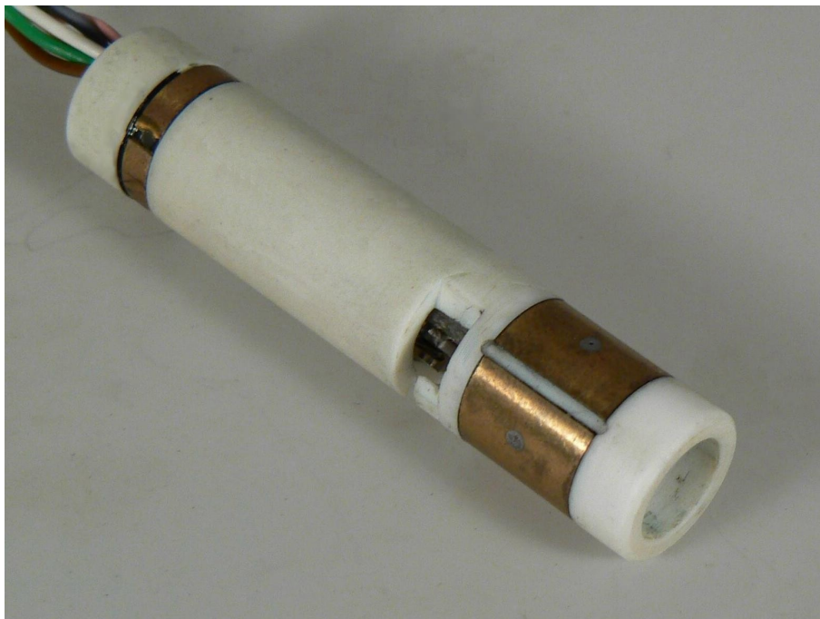
Abbildung 6.2: Messkopf aus Macor® mit vier Messflächen aus Messing
