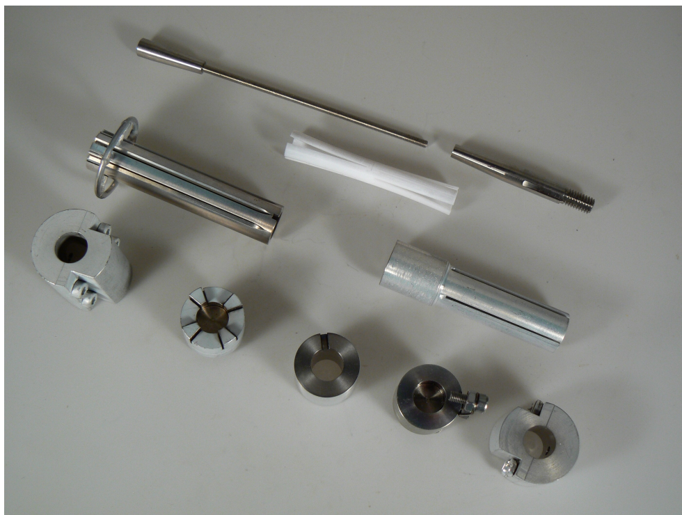
Abbildung 6.3: Masken zur Herstellung von Elektroden durch Sputtern
