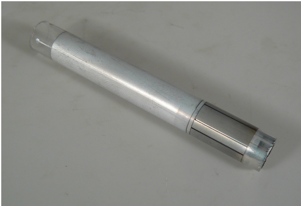
Abbildung 6.4: Messkopf mit strukturierten Schichten aus Aluminium
