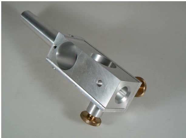
Abbildung 8.2: Handverstellbarer Zentrierer für Drehmaschine. Links Version mit Federsteg, rechts Version mit Federblechen.
