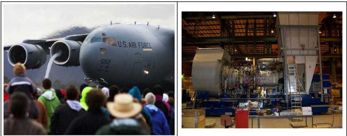
Abbildung 2-1 Inlet Vortex beim Triebwerksstart (links) [1], Stationäre Gasturbine mit Einlaufgehäuse (rechts) [2]
