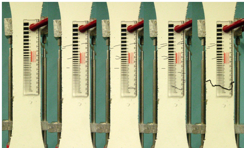
Abb. A1.86: Rissbilder bei 0 – 0,55 – 0,99 – 1,56 – 2,09 % Dehnung im Messbereich.
