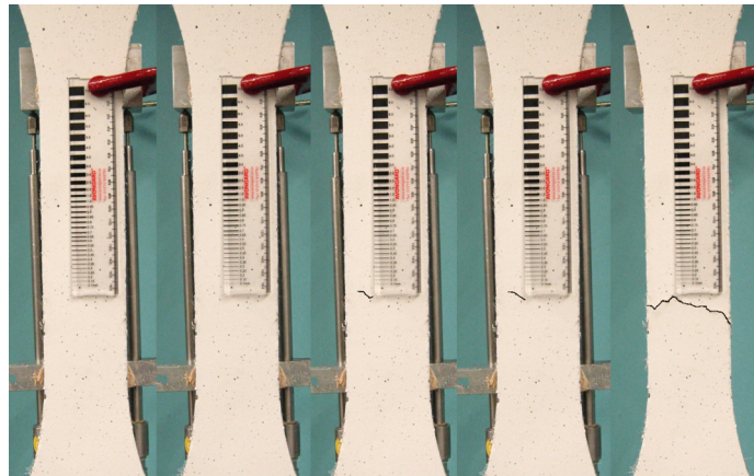
Abb. A1.108: Rissbilder bei 0 – 1,01 – 1,48 – 2,04 % Dehnung im Messbereich und nach Versagen.
