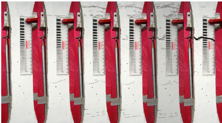
Abb. A1.76: Rissbilder bei 0 – 0,95 – 2,01 – 2,96 – 3,42 % Dehnung im Messbereich und nach Versagen.
