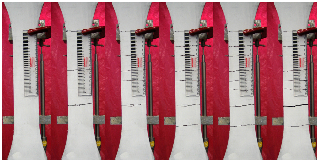
Abb. A1.9: Rissbilder bei 0 – 0,48 – 0,57 – 1,03 – 1,53 – 1,79 % Dehnung im Messbereich.
