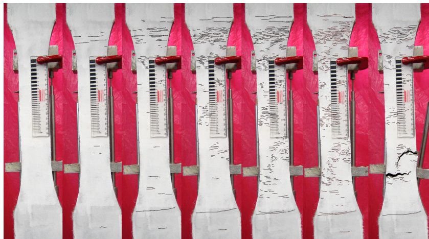
Abb. A1.72: Rissbilder bei 0 – 1,03 – 2,05 – 3,09 – 3,99 – 4,37 % Dehnung im Messbereich und nach Versagen.
