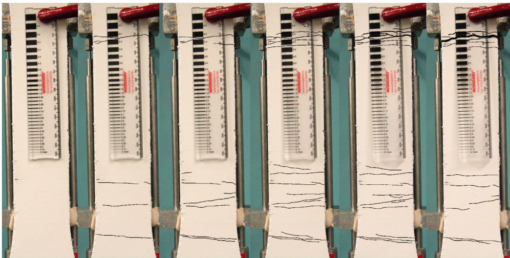
Abb. A1.88: Rissbilder bei 0 – 0,11 – 0,39 – 0,57– 0,92 – 1,80 % Dehnung im Messbereich.
