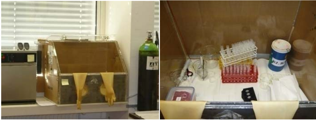
Abb. 6.16: Links : verwendete Anaerobkammer. Rechts : Innenansicht der Anaerobkammer mit den verwendeten Materialien.
