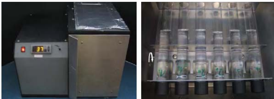
Abb. 6.15: End-Over-End Apparatur von außen (links) und innen (rechts) [Abbildung von Johannes Oidtmann zur Verfügung gestellt, Universität Halle].
