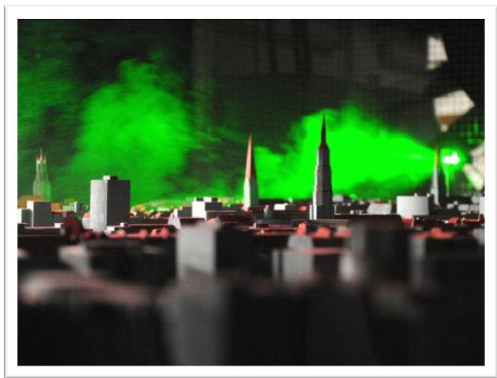
Abb. 29: Simulation der Schadstoffausbreitung anhand eines physischen Stadtmodells – Beispiel Hamburg (www.ndr.de; 16.11.2010)
