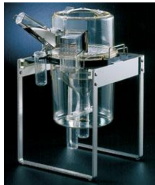
Abbildung 13: Stoffwechselkäfig Stoffwechselkäfig zur getrennten Sammlung der Ausscheidungsproben der einzelnen Ratten, Quelle: http://www.bioseb.com/bioseb/anglais/default/item_id=371_cat_id=15_Nalgene%20Metabolic%20Cage%20Systems.php , 08.10.2010
