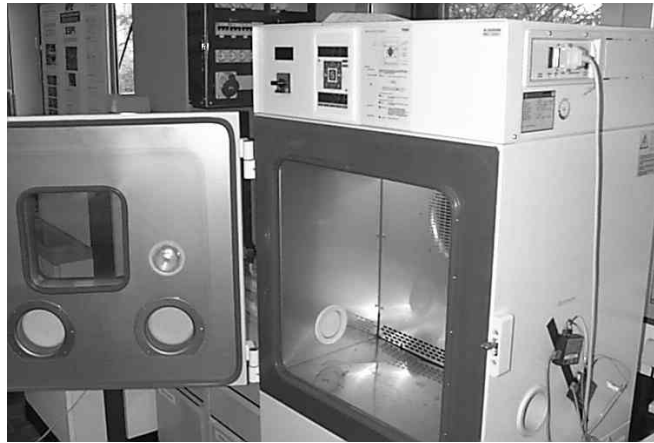
Abb. 3.4: Temperaturwechselschrank VT 4010 (Fa. Vötsch Industrietechnik)
