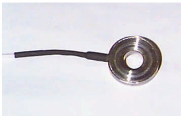
Abb. 3.5: Ringkraftmessdose Typ TMD 10 (Fa. Wazau)
