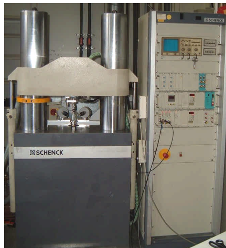
Abb. 3.2: Hydropulsator (Fa. Carl Schenck)
