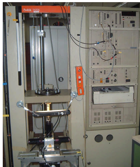
Abb. 3.1: Universalprüfmaschine (Fa. Zwick)
