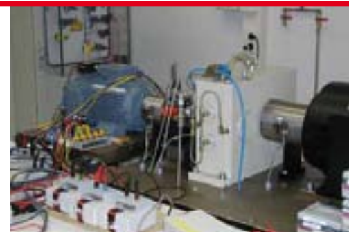
Versuchsaufbau zu „Torquemotor mit integrierter kontaktloser Energieübertragung in das Rotorsystem“
