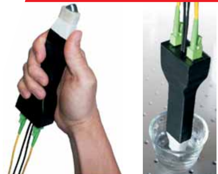
Fasergekoppelter THz-Flüssigkeitssensor. Mithilfe dieses Sensors lassen sich z. B. auch stark absorbierende Flüssigkeiten untersuchen. (Quelle: Fraunhofer IPM)
