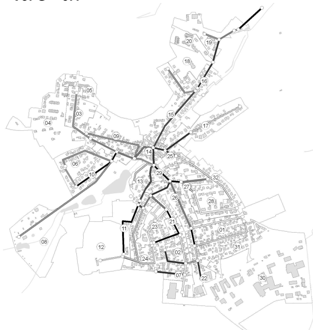
Abbildung 5-13: Fertigstellung der neuen Ableitungssysteme für Schmutzwasser in den Teilgebieten
