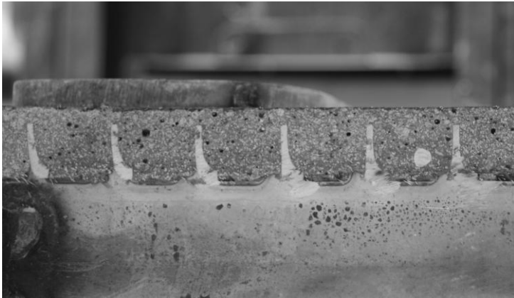
Abb. 6-17: Sägeschnitt Versuch T-2 mit unverformten Scharen
