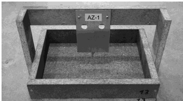
Abb. 6-2: Schalung eines Pull-out-Versuchskörpers
