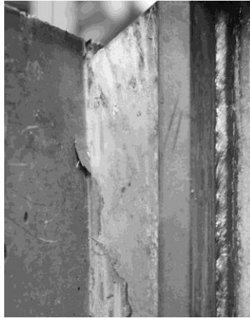
Abb. 3-11: oberflächliche Betonabplatzung eines Push-out-Versuchs
