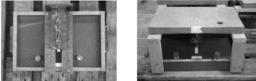
Abb. 3-7: Schalung eines Push-out-Versuchskörpers für liegende Betonage
