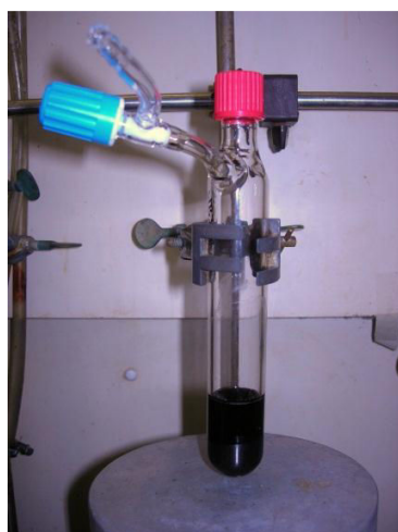
Abbildung 10-1. Typische Reaktionsdurchführung in einem Druckschlenkrohr.
