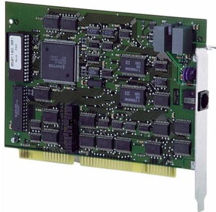
Abbildung 57: ISA-Bus-Controller, Quelle: Online-Produktkatalog Fa. Sauter
