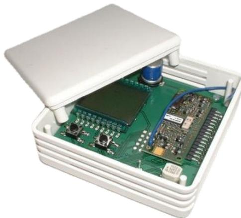
Abbildung 44: Ratio@-Gateway, Quelle: Online-Produktkatalog Fa. Omnio AG
