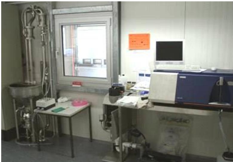
**Abb. 172** Innenansicht Laborcontainer der Deutsche Weintor AG mit Foss FT-120 (rechts) sowie Probennahme- Einrichtung (links) und Filtrationseinheit (Mitte)
