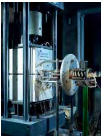
Ausziehversuch von einem Dübel – Risswechselfersuch mit Rissänderung
