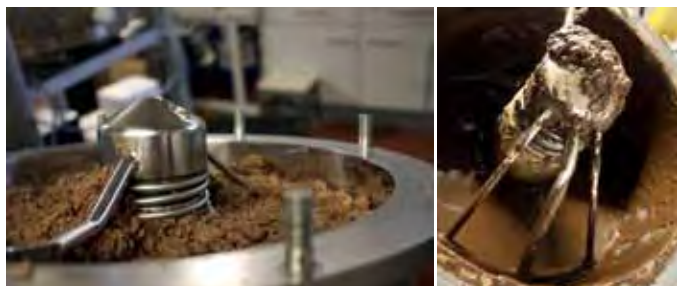
Abb. 2: Hydrolyse im Feststoffreaktor Terrafors-IS. Quelle: BioVT.
