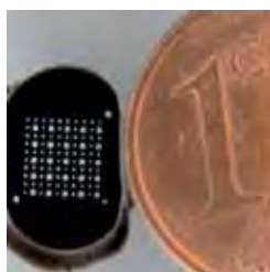
Abb. 2: Mikroblendenfeld, photolithographisch hergestellt
