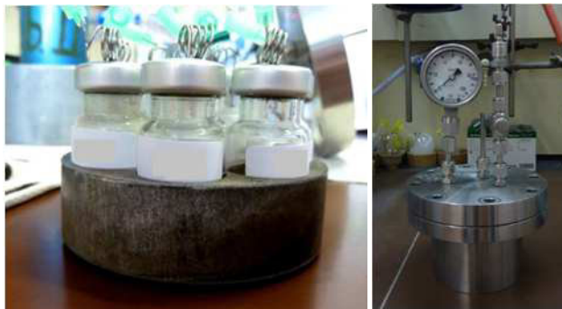
Abbildung 9. Aluminiumblock mit Reaktionsgefäßen und Edelstahlautoklaven.
