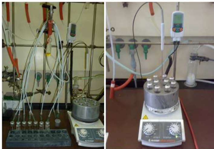
Abbildung 8. Vakuumverteiler und Aufarbeitungsreack sowie 10-fach Heizblock mit Reaktionsgefäßen.
