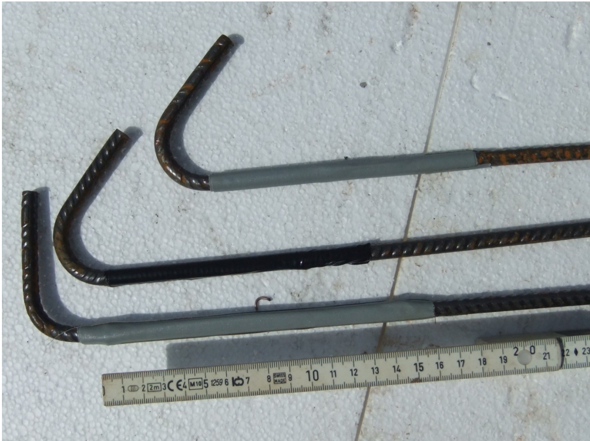
Abbildung 1: Haken mit Gewebepband zur Verbundschwächung
