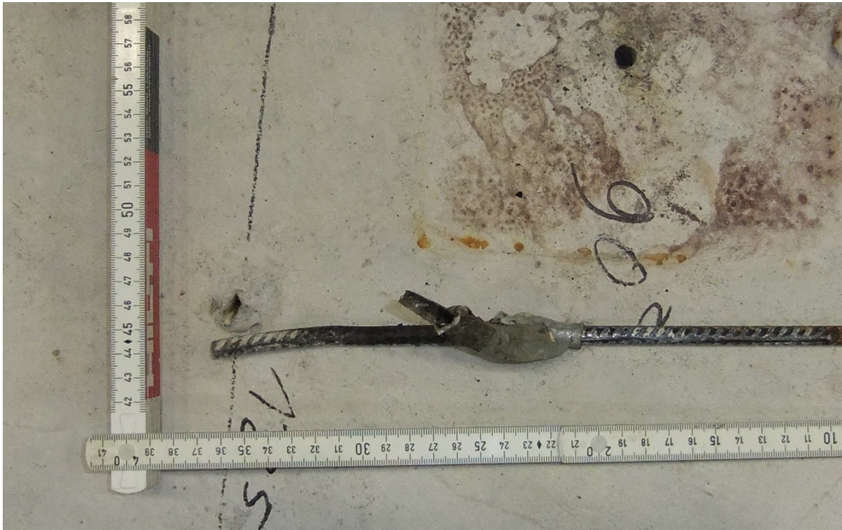
Abbildung 11: 90° Haken nach Versuch
