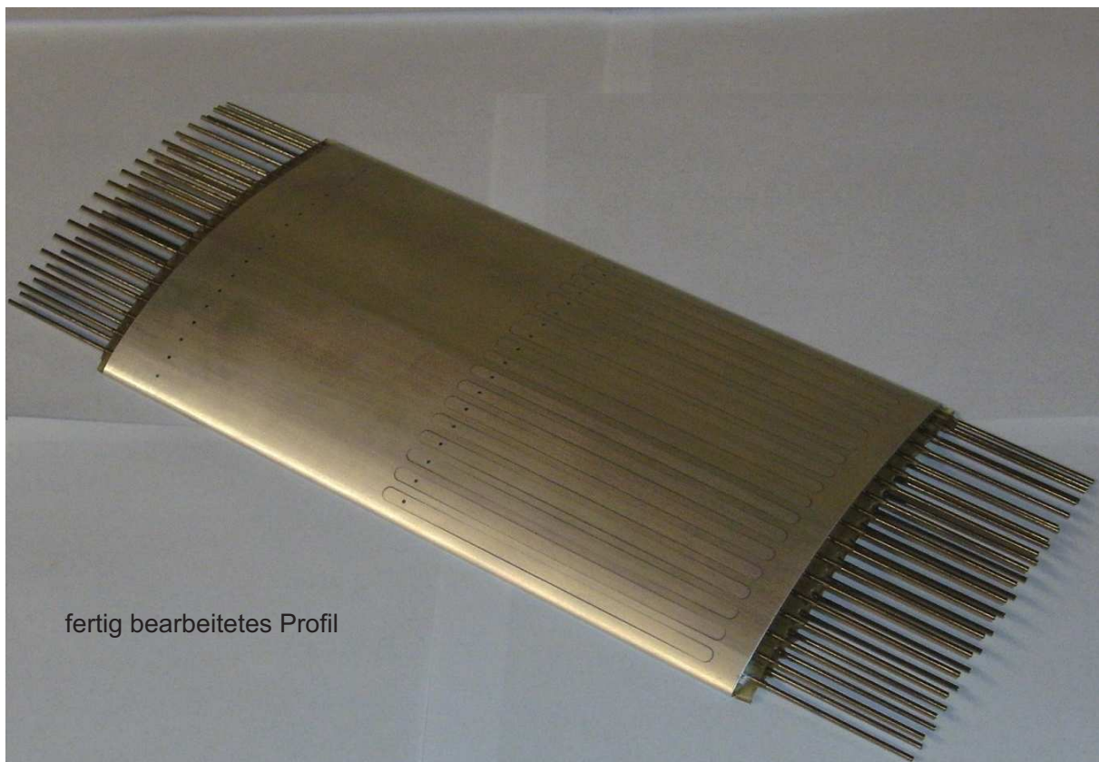
Abbildung 3.3: Beispielhaftes Profil zur Messung der Druckverteilung
