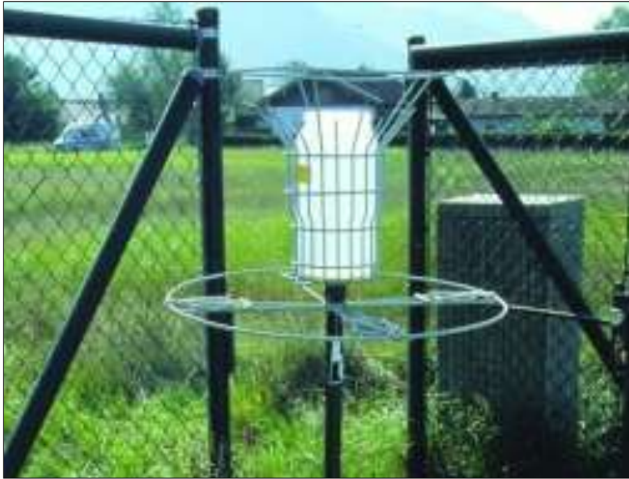
Bild 2-5: Bergerhoff-Sammelgefäß zur Staubniederschlagsmessung [LfU, 2012a]
