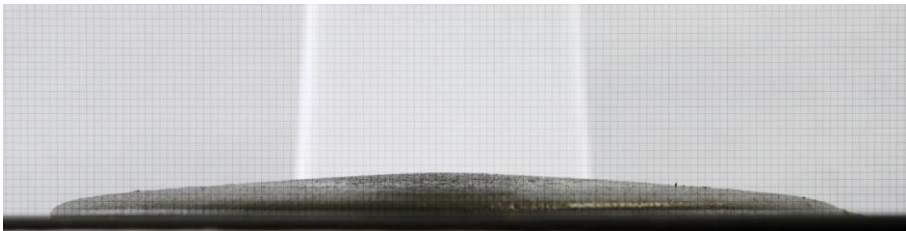
Abb. 3-3: Horizontale Aufnahme des Fließkuchens mit überblendetem Raster
