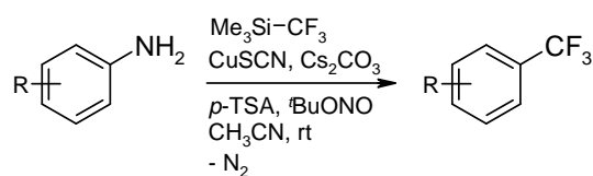
Schema 49: Sandmeyer Trifluormethylierung von Anilinderivaten.
